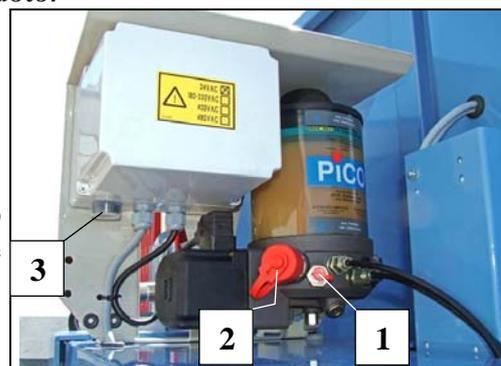
Fig. 32 Dispositivo di lubrificazione
