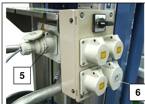
Fig. 19 Collegare la scatola di controllo
