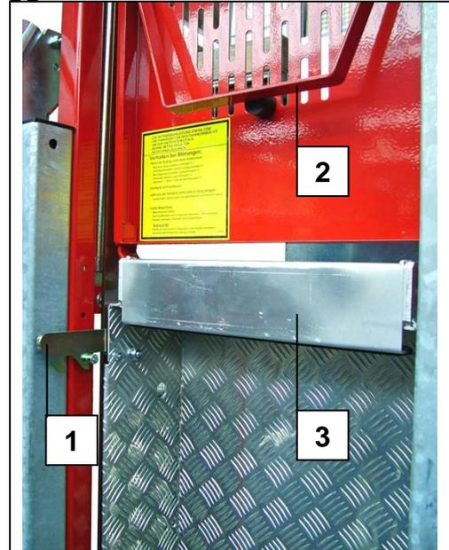
Fig. 32 Passerella per il montaggio chiusa
