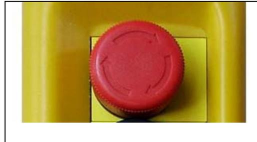
Fig. 42 Pulsante ad urto di ARRESTO D'EMERGENZA
